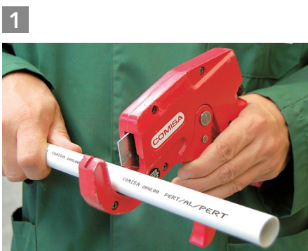
1 CUT / TAGLIO / ROHRABLÄNGEN / COUPER
