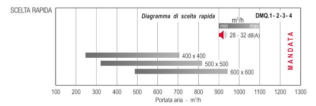
Il valore consigliato delle velocità dell'aria attraverso la superficie effettiva deve essere adatto ad un lancio medio con velocità finale in ambiente comunque inferiore a 0,3 m/s, per un valore della potenza sonora compreso tra 28 e 32 dB(A). Per un ulteriore approfondimento si rimanda alla consultazione del fascicolo tecnico.
